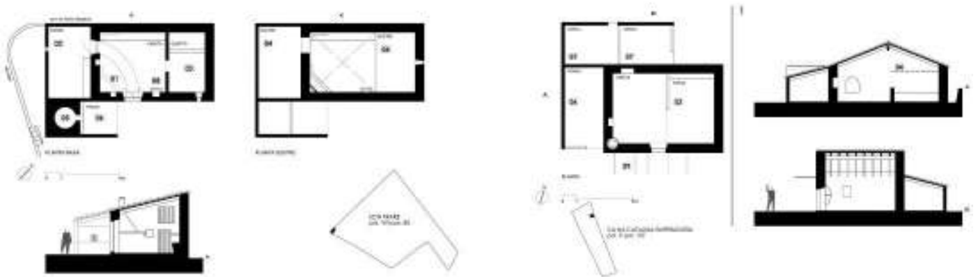
Son Frare (esq.) i Ca na Catalina Emperadora o sa Caseta Vella, emplaçada a la falda del Puig de Reig (dreta). Aquesta tipologia, que no és molt habitual, té la coberta a dos vents.
