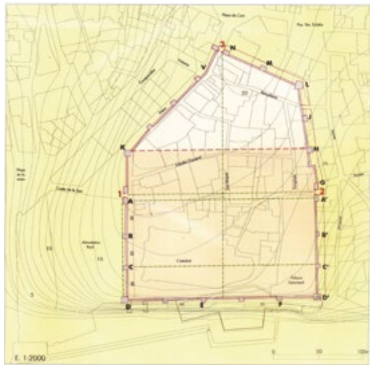
Figura 2.- Traçat hipotètic de les primeres muralles romanes (KDD'HK) i la seva possible ampliació (HLNK) sobre el pla viari actual. Les corbes de nivell corresponen a la topografia original. (Autor C.G.Delgado)
